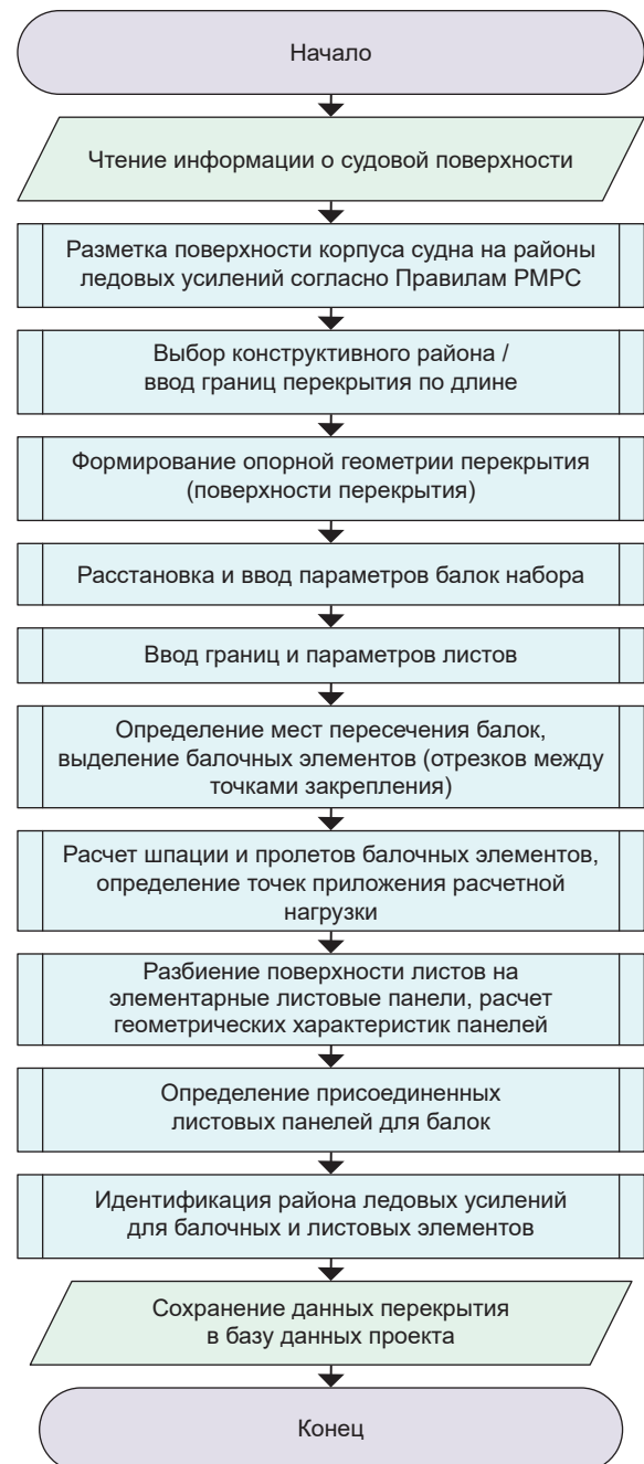
Рис. 2. Алгоритм формирования базы данных по перекрытию Fig. 2. Algorithm for the grillage database generating
