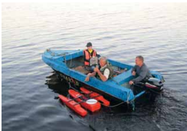
Рис. 2 Измерение расходов воды с помощью профилографа «WORK HORSE Rio Grande 1200»
