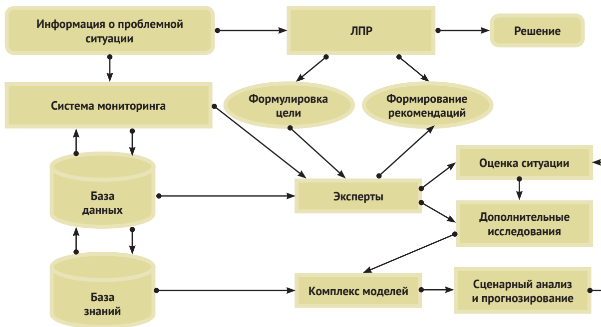
Рис. 7. Укрупненная схема обработки входной информации с использованием системы мониторинга кризисных ситуаций
