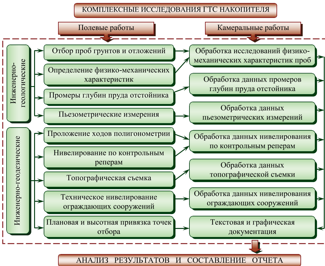
Рис. 2. Блок-схема проведения комплексных исследований состояния ГТС накопителя жидких промышленных отходов
