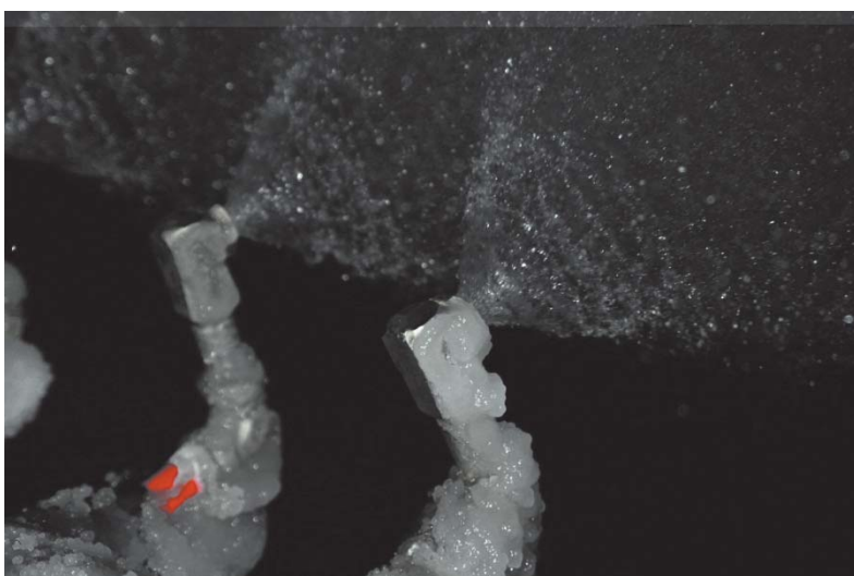
Рис. 6. Распыление воды форсунками при приготовлении моделированного ледяного поля
