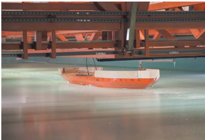
Рис. 7. Буксировочные испытания модели в новом ледовом бассейне
