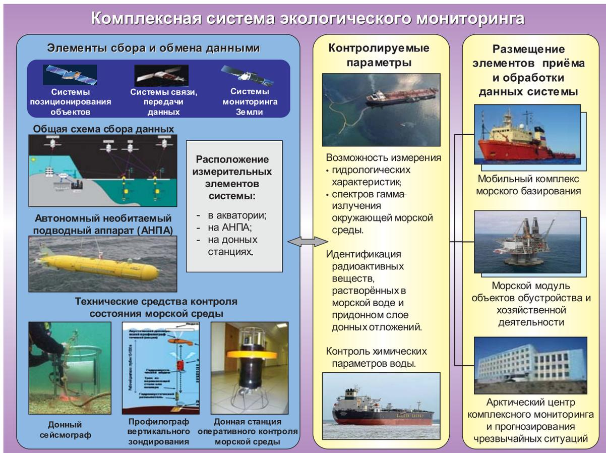
Рис. 6. Основные измерительные модули интегрированной системы контроля аварийных ситуаций
