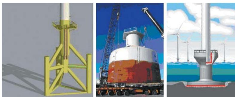
Рис. 2. Альтернативные опорные конструкции: а — тренога с возможностью забивки свай в подводном положении; б — перевернутый ковш, засасываемый с помощью вакуума (имеет большие перспективы, поскольку его изготовление, обработка и монтаж дешевле традиционных, а перемещение легче); в — гравитационный фундамент с развалом в надводной части и закреплением башни цементным раствором
