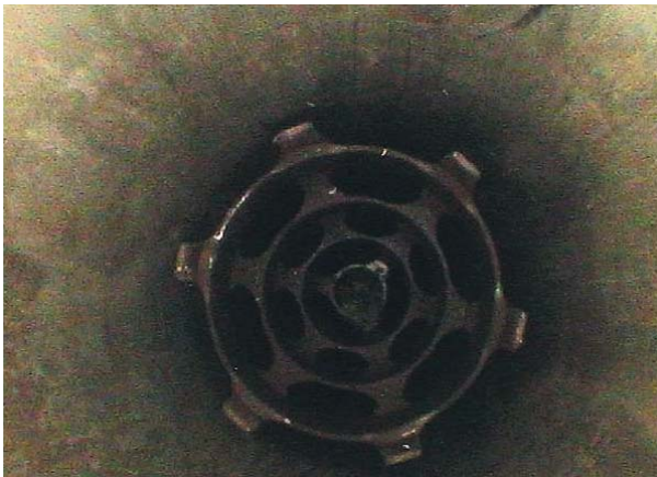
Рис. 21. Вид на верхнюю часть оборванной ОТВС в контейнере типа 6 № 26 в ячейке 0
