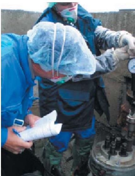
Рис. 7. Проведение динамометрии ОТВС: 1 – ОТВС заклинена; 2 – ОТВС с большим уровнем начального усилия F_{st} и трением скольжения (затираание) F_{max} при выдвигании ОТВС; 3 – ОТВС с типичным уровнем начального усилия F_{st} и усилия скольжения F_{min} ; 4 – ОТВС с оборванной активной частью
