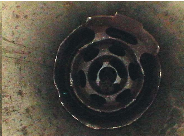
Рис. 22. Вид на верхнюю часть оборванной ОТВС в контейнере типа 6 № 26 в ячейке 3. Требуется установка захвата типа «Ерш» Ø26
