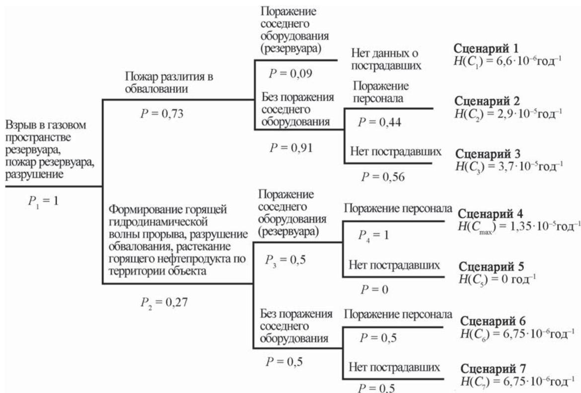
Рис. 7. «Дерево событий» при взрыве резервуаров с нефтепродуктами при отрицательных температурах
