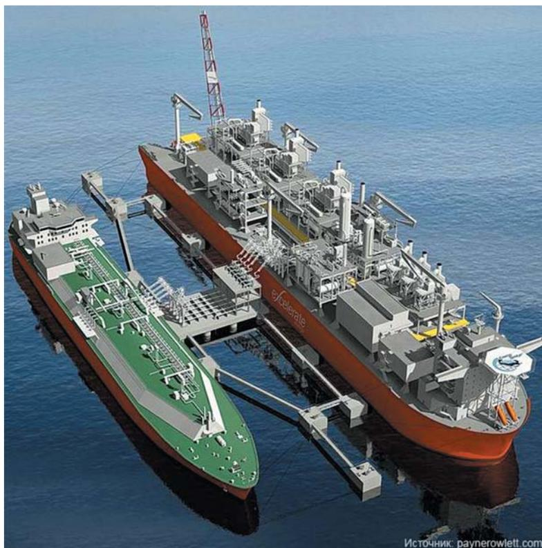
Рис. 1. Первый в мире плавучий завод по производству сжиженного газа компании «Royal Dutch Shell»
