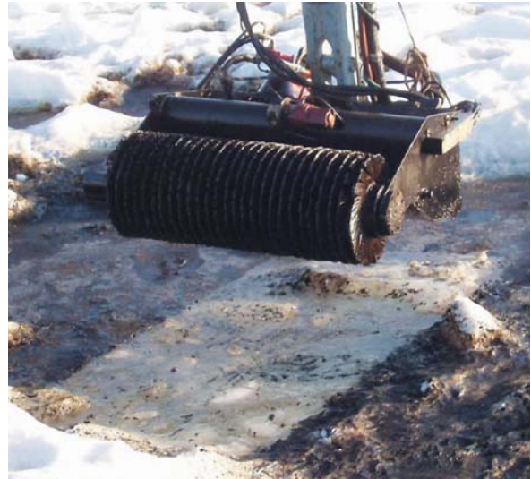
Рис. 4. Сбор со льда разливов нефтепродуктов в Финском заливе
