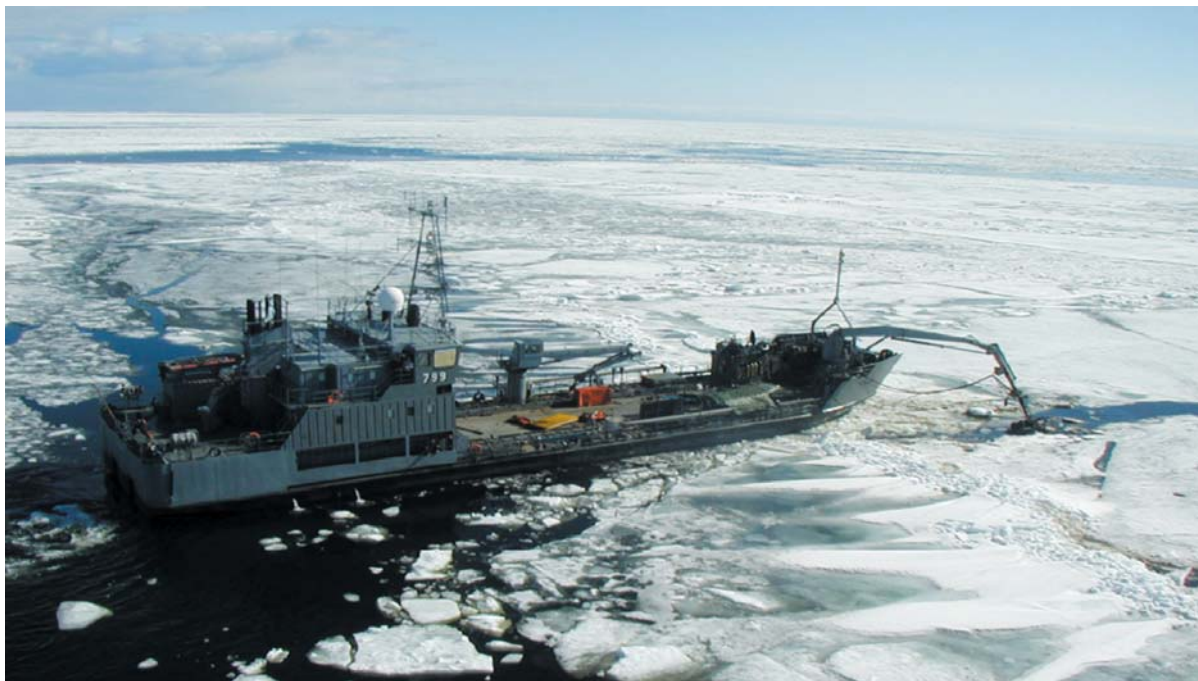
Рис. 3. Сбор со льда разливов нефтепродуктов в Финском заливе
